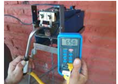
Pirómetro indicando la temperatura apropiada de la cuchilla de 650°C.
