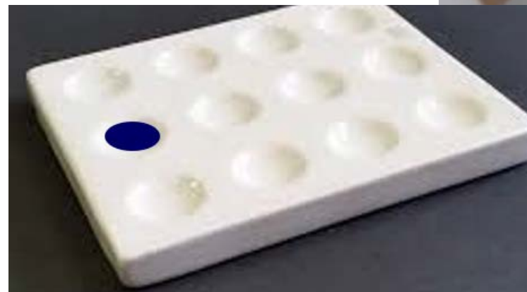
Placa de toque: solución de ánodo + solución de almidón.
